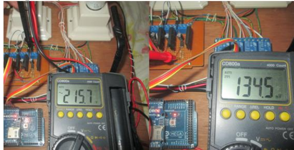
Gambar 8. Pengujian rangkaian sensor tegangan
