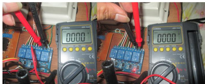
Gambar 10. Pengujian rangkaian Relay
