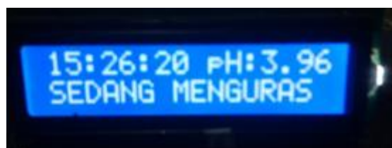
Gambar 12. pH air dalam keadaan tidak normal dan pompa air sedang mengisi
